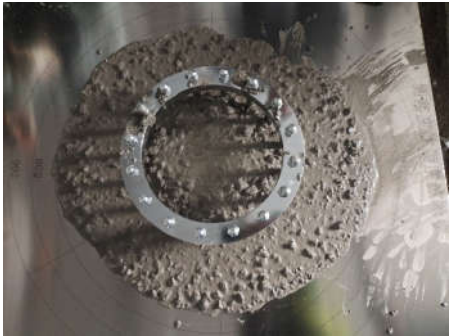
图2 自密实混凝土J环试验
