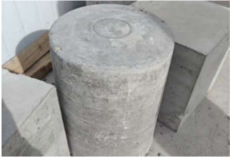
图3 自密实混凝土样板制作
