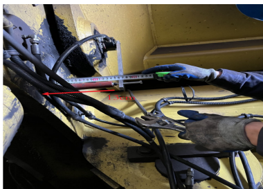
图 3 角度传感器安装位置图
