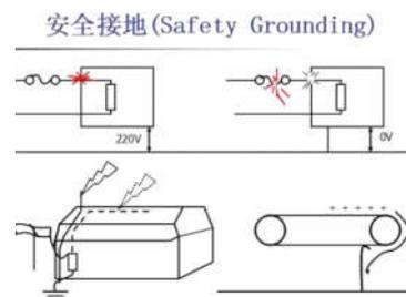
图1 安全接地示意图
