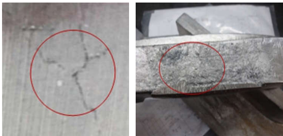
图4 裂纹-缩松-气孔-夹渣缺陷示例
