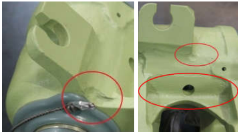
图2 铸件缺陷部位
