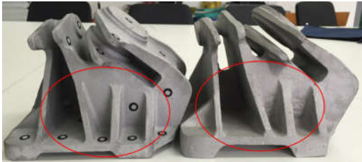
图7 两种方法所生产零件尺寸精度对比简图
