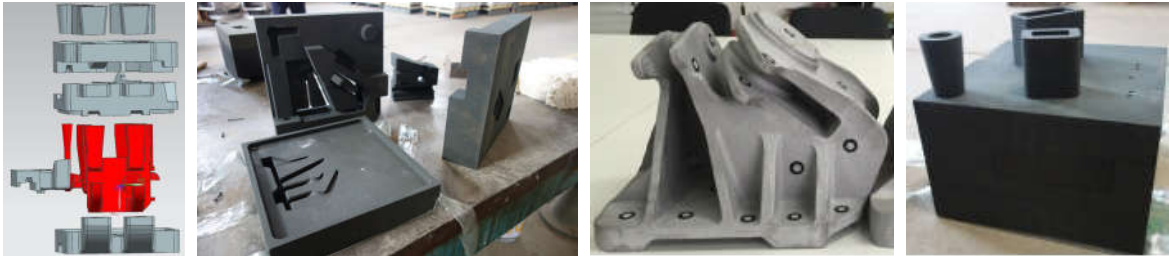
图5 打印方案数模-打印成品树脂砂型-树脂砂型组合-浇注成形铸件
