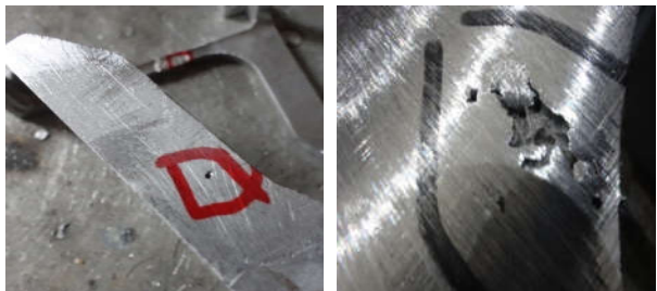
图4 裂纹-缩松-气孔-夹渣缺陷示例
