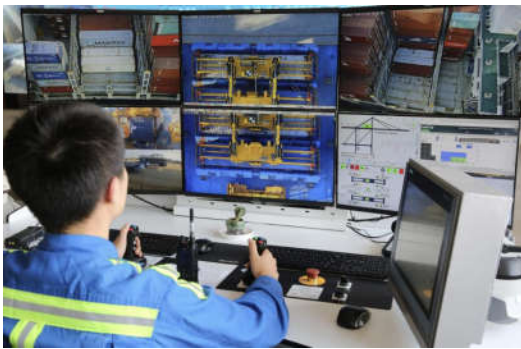
图1 TRC远程控制系统于工业自动化场景下,展现远程控制及数据采集功能
