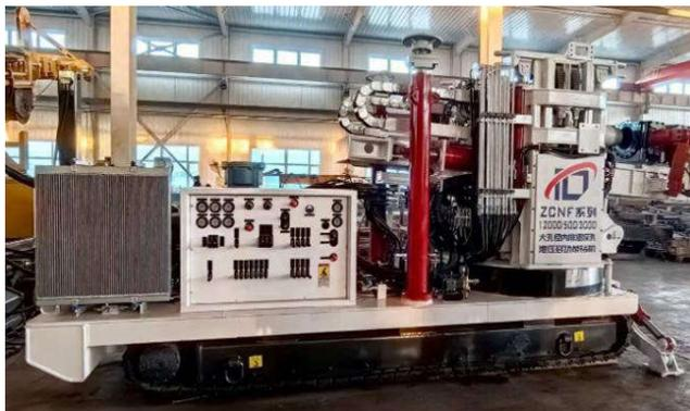
图2 瓦斯钻抽一体化钻机外观
