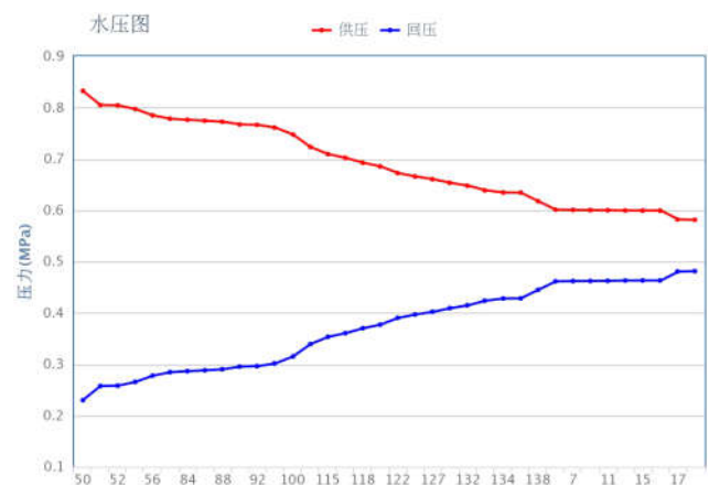
图2 电厂1-3#热源至最不利用户管道水压图
