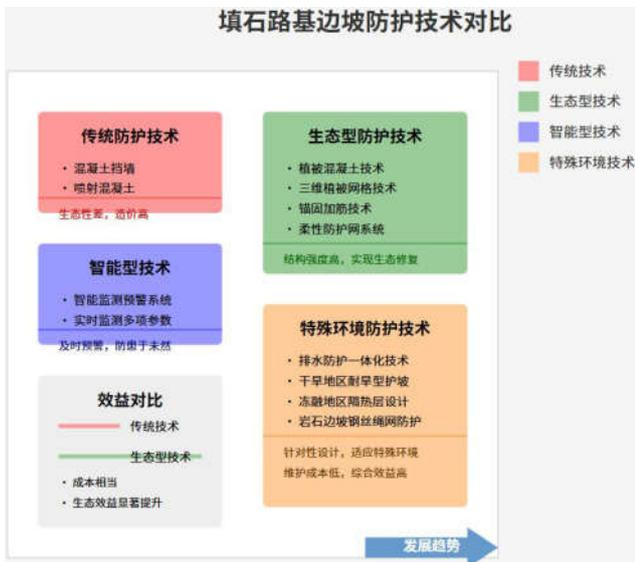
图2 填石路基边坡防护技术对比
